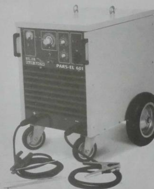
شکل ۱ - ۴ تجهیزات جوشکاری دستی شامل مولد، کابل اتصال به فلز پایه، کابل انبر، و الکتروود روکش دار.
